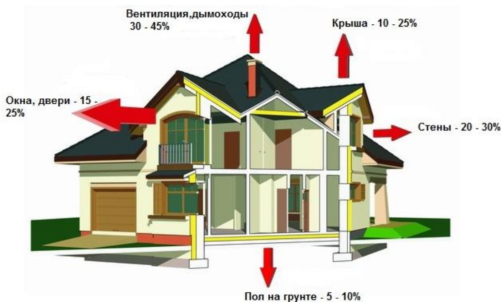
Рис. 2. Потеря тепла в доме, возведенном по традиционной технологии и из традиционных строительных материалов
