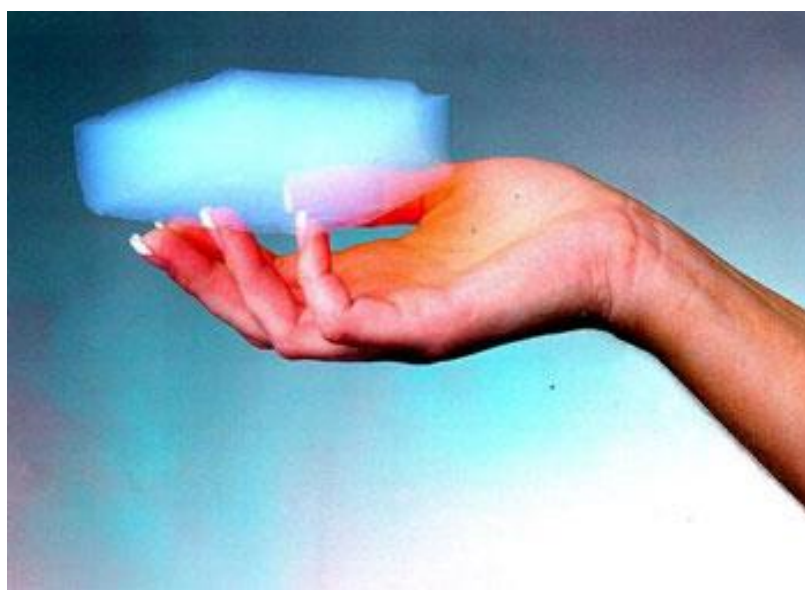
Рис. 31. Технический твёрдый аэрогель
