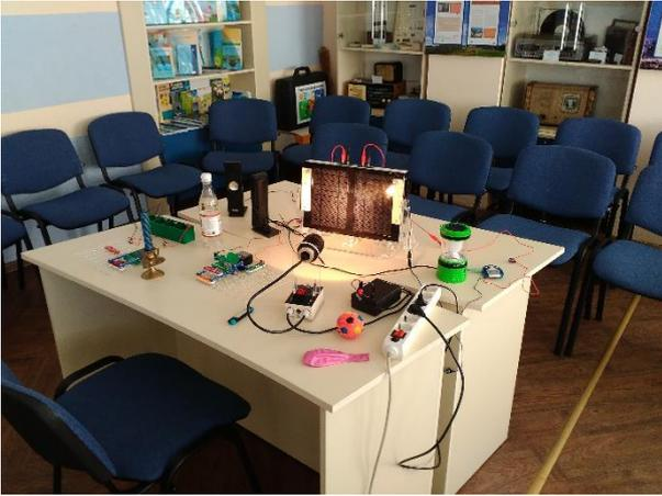
2 опыт. «Выработка электрической энергии за счет движения лопастей мотора струей воздуха». Мотор подключается к светодиоде. При подачи струи воздуха от фена на лопасти происходит вращение пропеллера и выработка электрической энергии.
