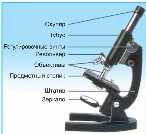
Рис. 8. Световой микроскоп
