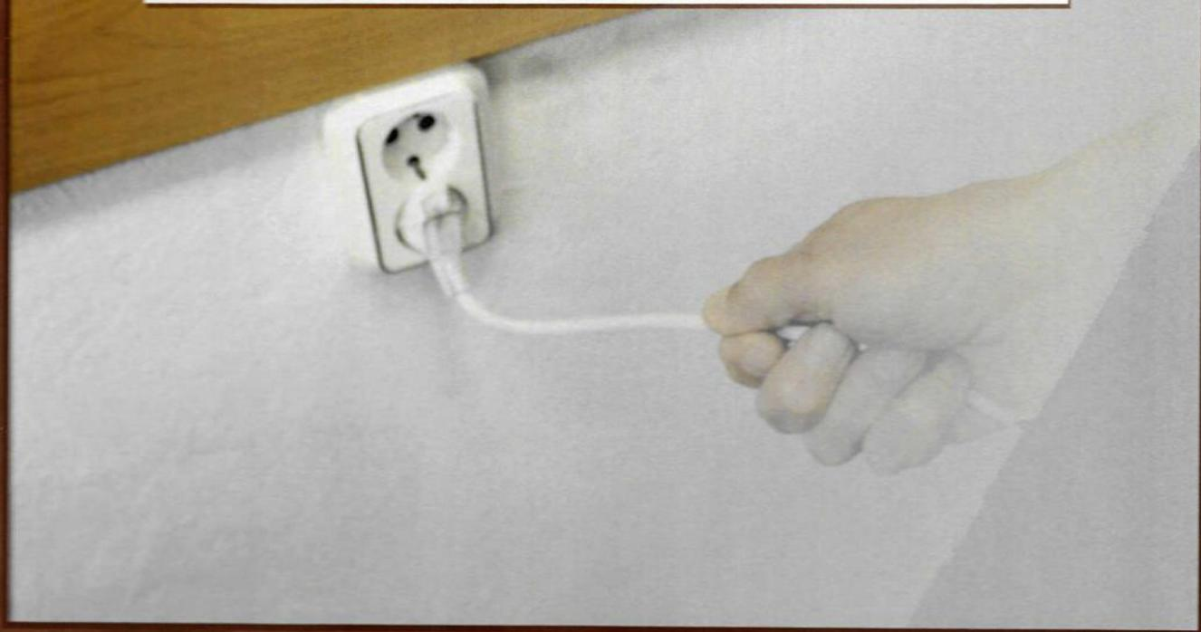
**Нельзя!** Электроаппарат с такой вилкой (наличие третьего проводника) относится к I классу защиты от поражения электротоком и должен подключаться к трехпроводной электрической сети.
