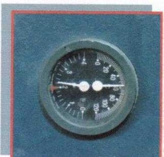
достигает давления в водопроводной сети, это свидетельствует о замерзании системы отопления. В этом случае котел разжигать категорически запрещается.
