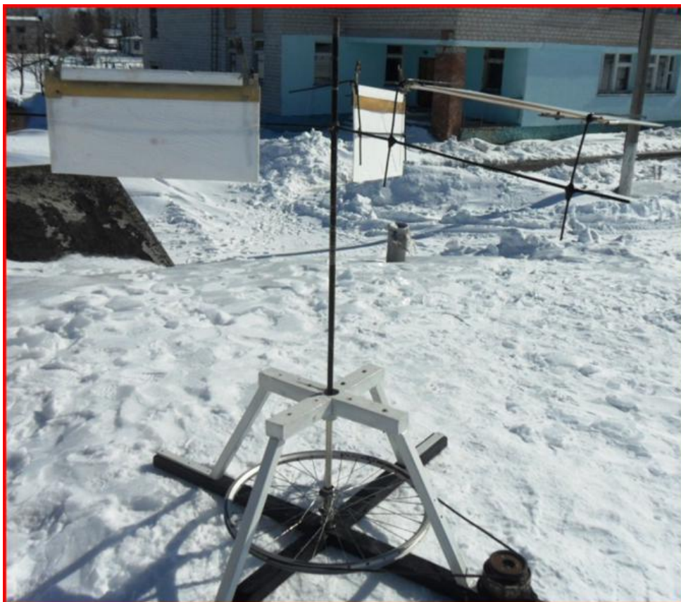
Фото 1. Ветроустановка с осью паруса в горизонтальной плоскости (Электрогенератор – двигатель постоянного тока)
