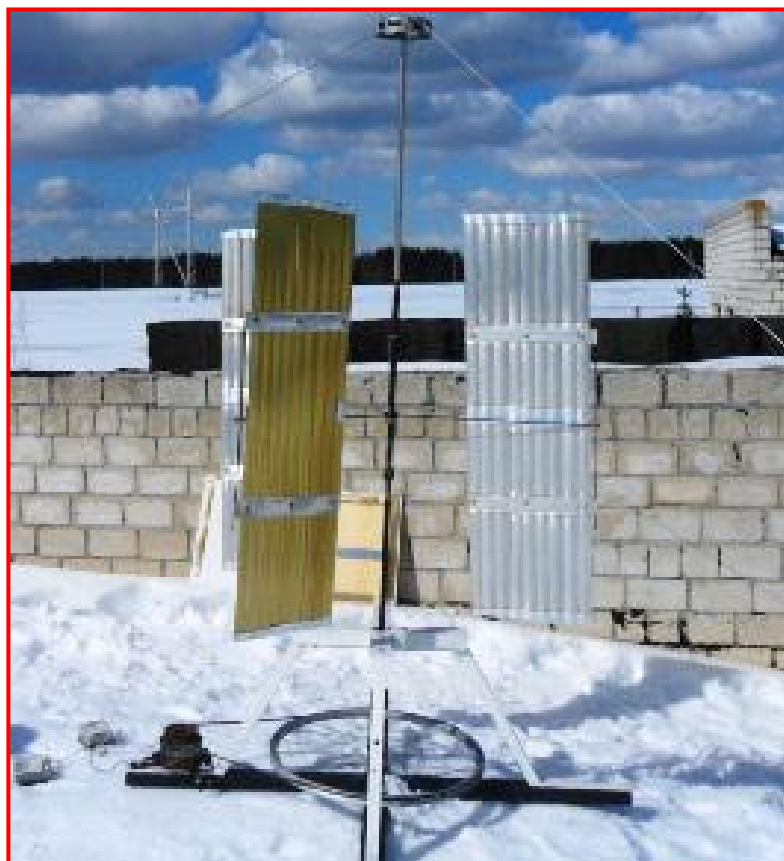
Фото 3. Ветроустановка с вертикальной осью паруса (Площадь паруса 0,33 \text{ м}^2 )
