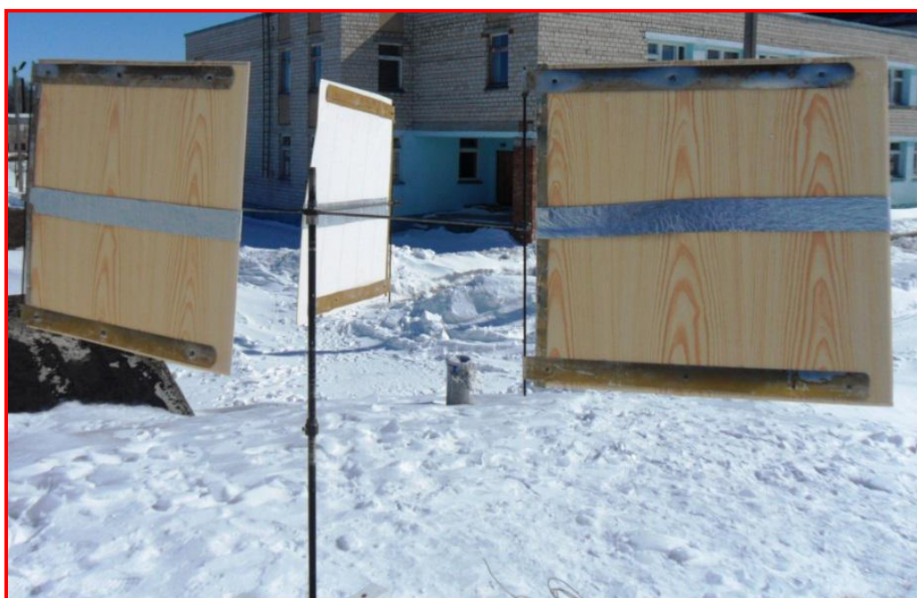
Фото 2. Ветроустановка с вертикальной осью паруса (Площадь паруса 0,25 м 2 )
