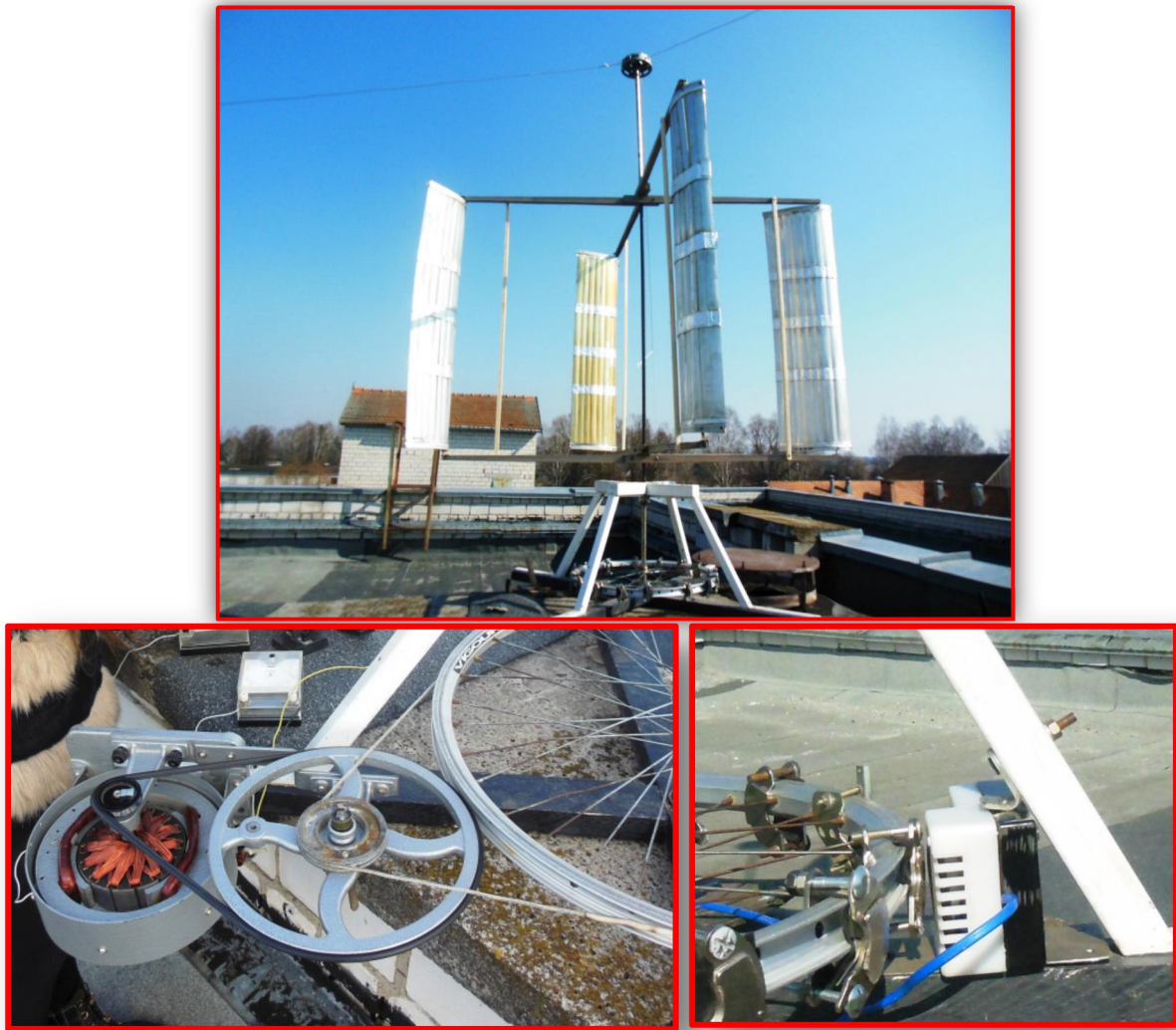
Фото 5. Ветроустановка с вертикальной осью паруса и генераторы (Четыре паруса с профилем крыла)
