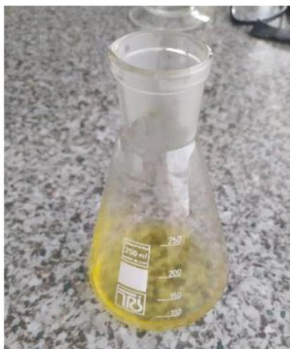
Рисунок 3.6 – Смесь для определения КЧ до начала титрования
