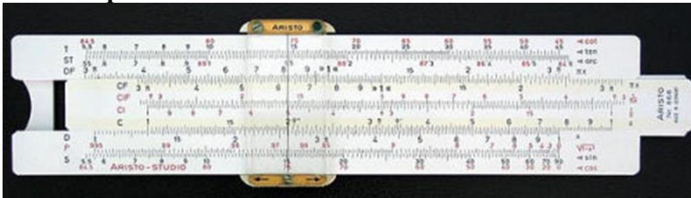
**Логарифмическая линейка** — это счетный прибор, применявшийся до появления калькуляторов и персональных компьютеров. Это было достаточно универсальное устройство, на котором можно было умножать, делить, возводить в квадрат и куб, вычислять квадратные и кубические корни, синусы, тангенсы и другие значения. Выполнялись эти математические операции с достаточно большой точностью — до 3–4 знаков после запятой.
