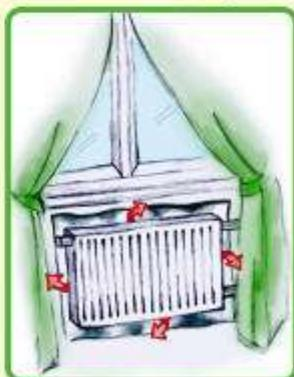
**Между радиаторной батареей и стеной установите защитный экран из алюминиевой фольги. Фольга отражает тепло и направляет его обратно в комнату (экономия до 4%)**
