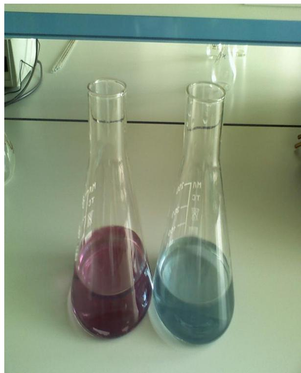
*Ход определения жесткости воды*
